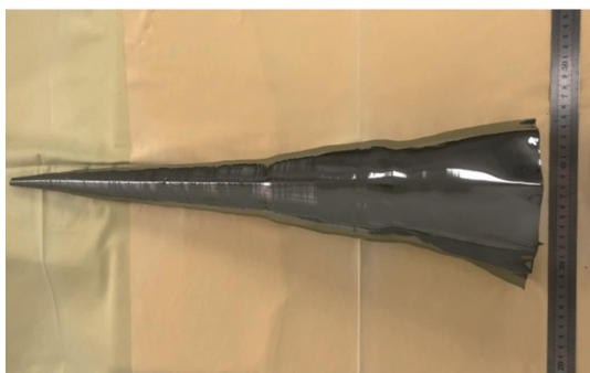
图 2 5 in InSb 单晶晶锭
