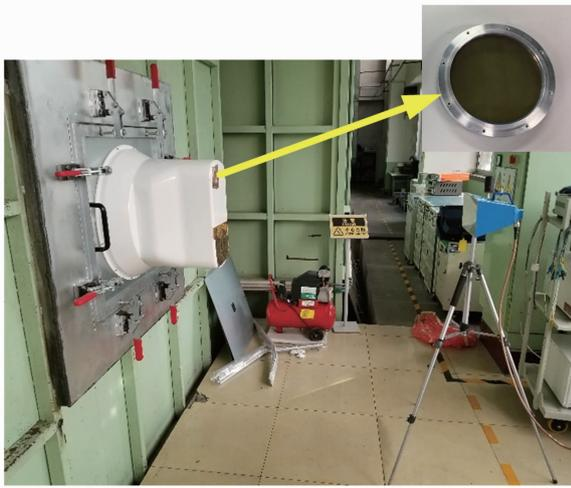
图 8 电磁屏蔽效能测试环境和测试样机
