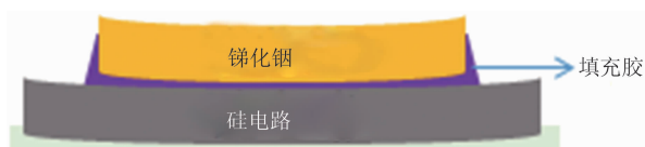
图 3 混成芯片翘曲形态示意图
