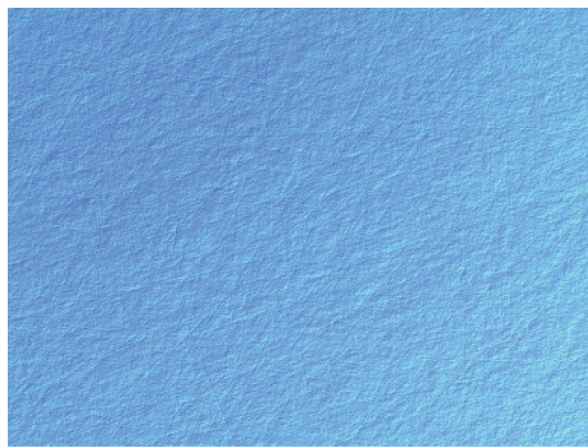
图 1 机械抛光后碲锌镉衬底表面照片(100 \times )
