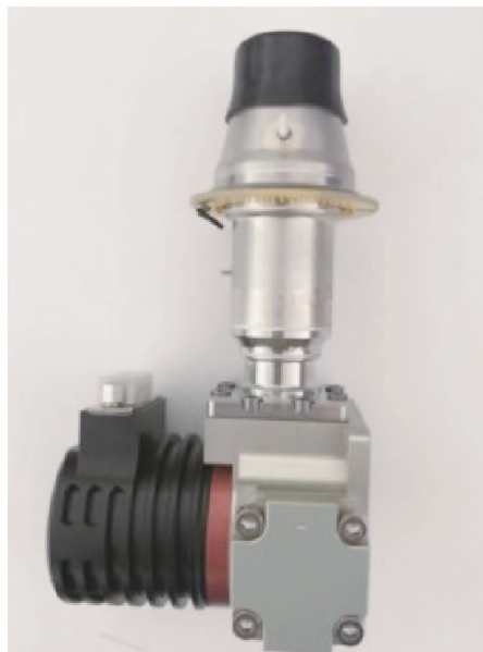
图 1 像元尺寸为 12 \mu\text{m} \times 12 \mu\text{m} 的 1280 \times 1024 制冷型中波红外探测器组件的实物图
