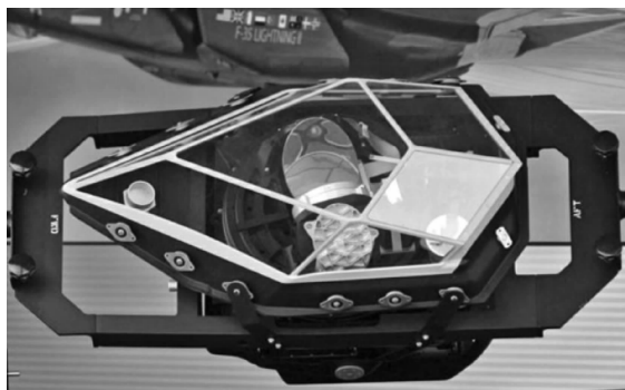
图 6 F-35 战斗机的 EOTS 光学窗口
