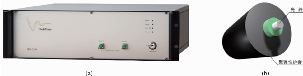
图 5 (a) BOFDA 测试仪器 fTB2505; (b) 测试光纤
