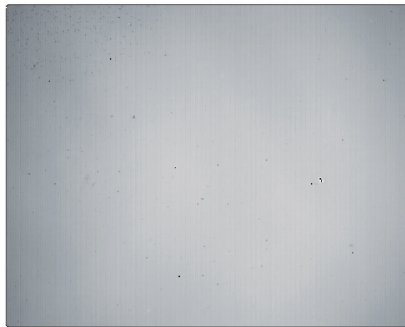
图 1 某中波 320 \times 256 碲镉汞探测器的信号电平图
