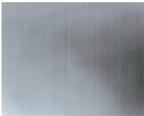
图 8 10 \mu\text{m} 间距长波 1280 \times 1024 探测器的电平图 率大于等于 99.4%，非均匀性小于等于 4%）， 为小间距长波碲镉汞探测器的研制打下了坚实 的基础。进一步提高小间距长波碲镉汞探测器 性能及批量生产能力是下一步的研制重点。
