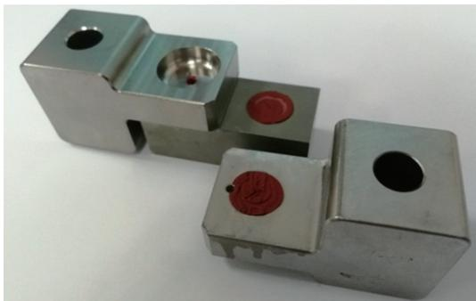
图 5 剪切试件的破坏形式
