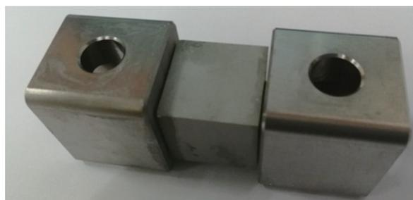
图 4 拉伸试件的实物图
