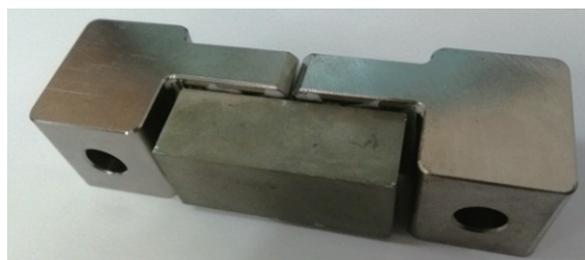
图 3 剪切试件的实物图
