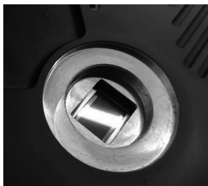
图 9 相机保护玻璃及其端面的反光现象
