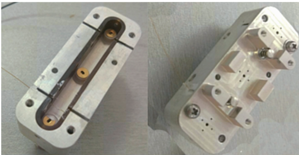
图 5 粘贴光纤光栅的射频同轴开关的实物图
