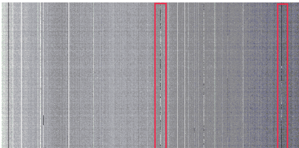
图 2 存在闪元时的线列红外探测器扫描图像
