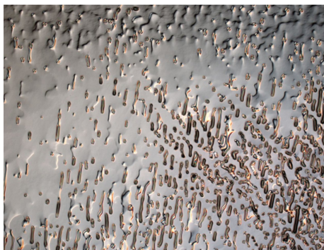
图 8 区域性连续存在的长条形缺陷在光学显微镜下的形貌
