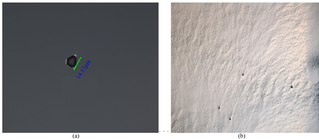
图 5 缺陷形貌: (a)碲锌镉衬底上的缺陷; (b)外延后碲镉汞薄膜的表面形貌
