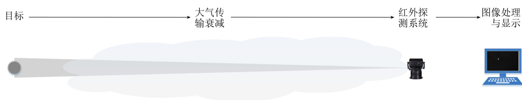
图 1 典型红外系统的目标探测原理图
