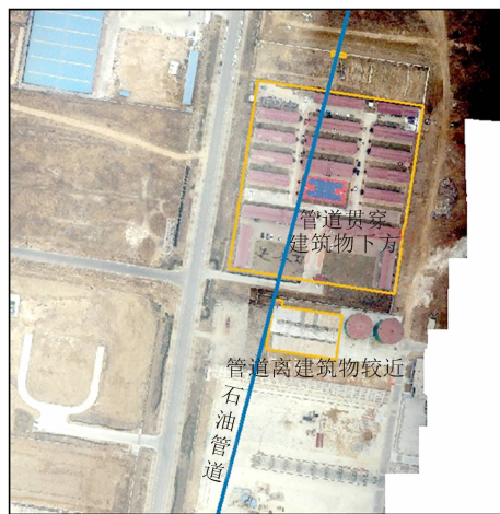
图 3 地表建筑占压管道或距离管道过近等隐患
