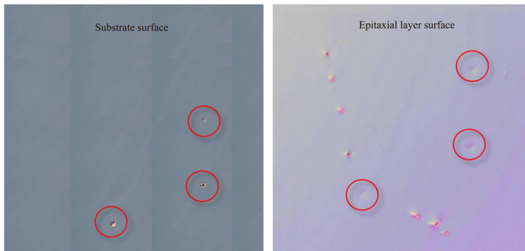
图 5 用光学显微镜观察到碲镉汞外延层中的表面缺陷与碲锌镉衬底中的表面缺陷之间的相关性。在相同区域中观察薄膜层和衬底的表面形态。其中, 红色圆圈表示衬底中的表面缺陷与碲镉汞薄膜的表面缺陷之间的相关性
