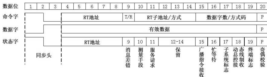
图 2 1553B 总线的字格式
