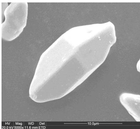
图4 经过 550 °C 热处理后的样品 (5000×)
