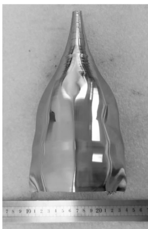
图 5 直径为 100 mm 的低位错密度 InSb 单晶
