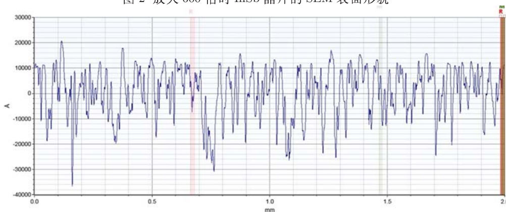
图 3 线切割 InSb 晶片的表面粗糙度
