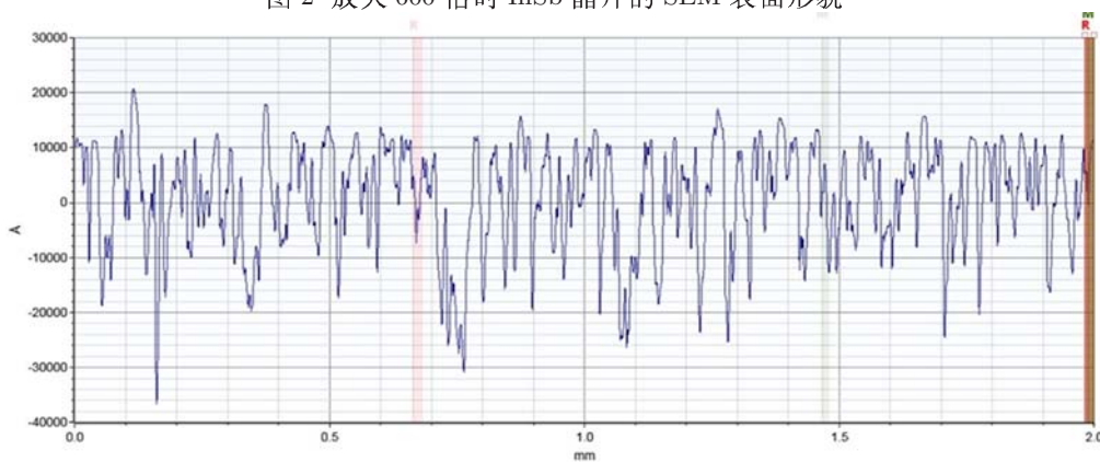
图 3 线切割 InSb 晶片的表面粗糙度
