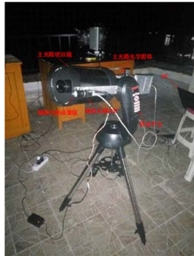
图2 成像光谱仪和转动平台的实物图
