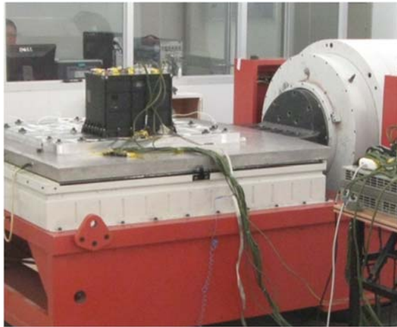
图 3 电控箱动力学试验的实物图
