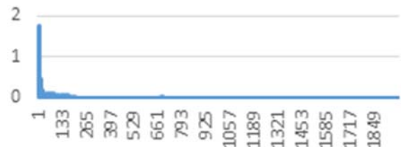
图 6 有滤波器时功率分析仪的 FFT 分析结果
