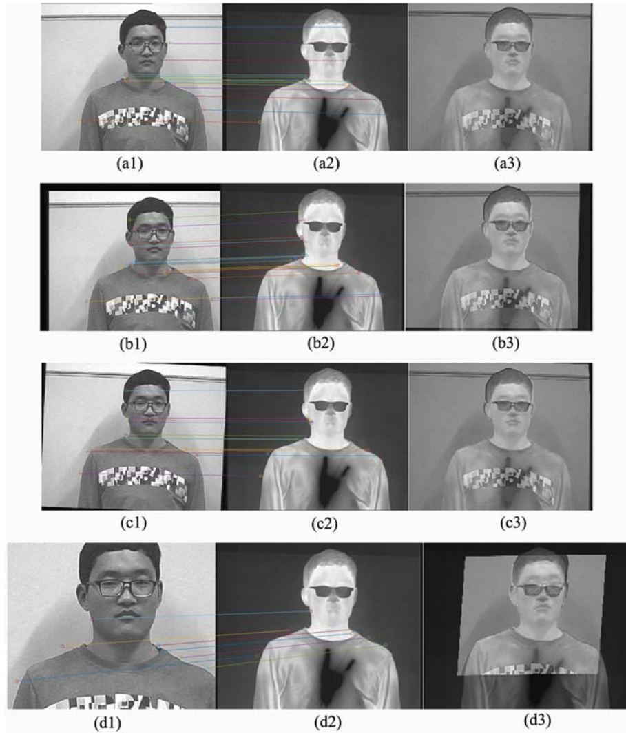
图 5 原始微光图像 (a1) 经过平移 (b1)、旋转 (c1)、缩放 (d1) 后与红外图像的配准和融合结果
