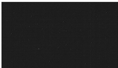
图 8 灰度梯度法的盲元检测结果
