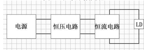
图 2 激光器电路的设计框图
